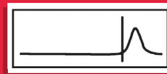
Prerušený vodič/Koniec kábla
