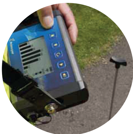
Mikron 3 Pro a zemný mikrofón
