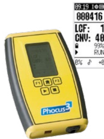
Komunikátor zobrazuje faktor pravdepodobnosti úniku (LCF), kritickú hodnotu zvuku (CNV) a umožňuje taktiež priamy odposluch poruchy.
