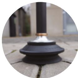
Kroková sonda pre detekciu únikov z podzemných plynovodov
