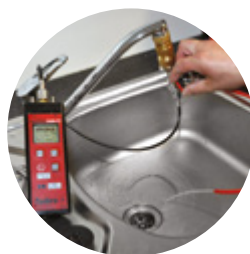
Nielen meranie tlaku plynu, ale aj tlaku vody
