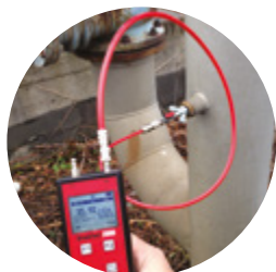
Jednoduchý tlakomer na meranie tlaku a podtlaku vzduchu/plynu
