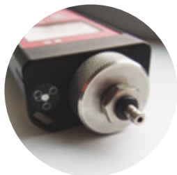
Nasávacie čerpadlo s výkonom 25 l/h
